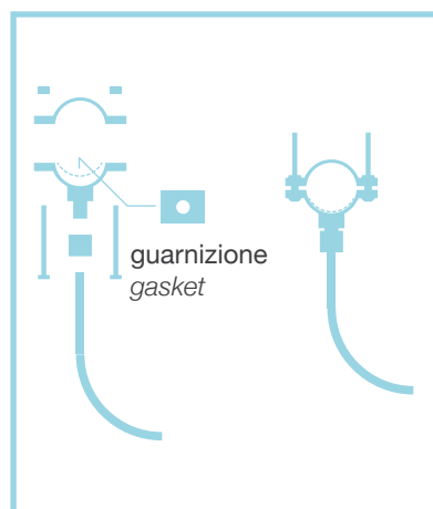
kit assemblaggio staffa scarico drain clamp kit assembly
